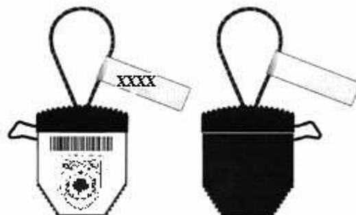
Fig. 8. Forma e plumbçes plastike me vulë verifikuese
